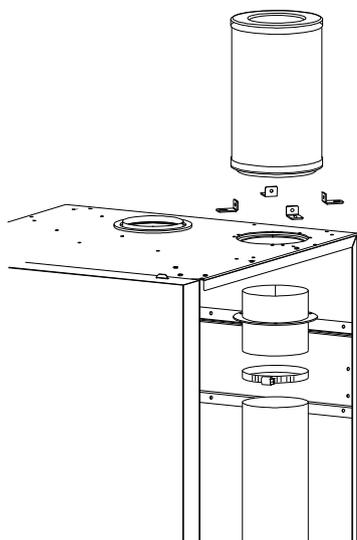
Если WALLCON будет эксплуатироваться в запыленной окружающей среде, то котел должен быть оборудован фильтром входящего воздуха. Этот дополнительный фильтр должен регулярно проверяться.
