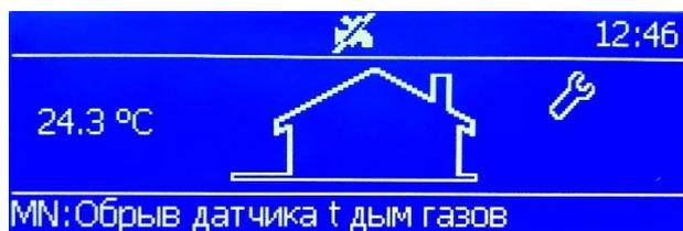
Котлы **Wallcon** оснащены системой диагностики неисправностей.
