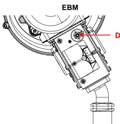
Поверните винт регулировки минимального расхода газа (D) по часовой стрелке, чтобы увеличить значение CO<sub>2</sub>. Если вы повернете его против часовой стрелки, расход газа уменьшится и, следовательно, количество CO<sub>2</sub> тоже уменьшится.
