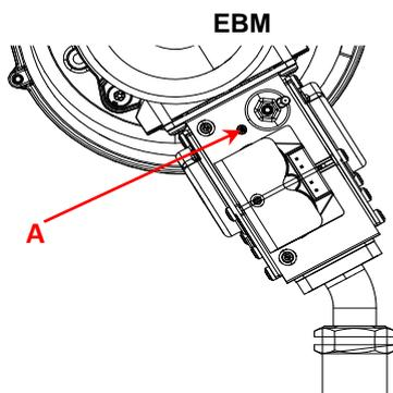
Поворачивайте винт регулировки объема подаваемого газа в номинальном режиме (A) по часовой стрелке для увеличения значения CO<sub>2</sub>. Если поворачивать этот винт против часовой стрелки, то расход газа будет уменьшаться и, таким образом, будет уменьшаться и значение уровня CO<sub>2</sub>.
