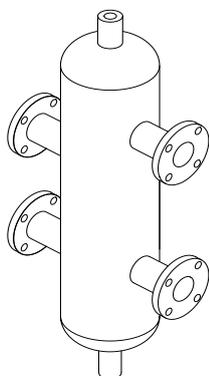
Гидравлический разделитель применяется для компенсации перепадов давления в системах, где используется несколько насосов и/или контуров отопления, для устранения чрезмерной разницы давлений и температур воды на входе и выходе котла и для предотвращения тепловых напряжений в котле.
