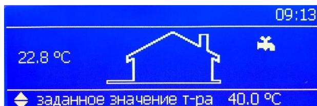
Если вы установили временную программу, вы не можете изменить эту настройку. Если вы хотите управлять котлом/каскадной системой вручную, за исключением временной программы, необходимо установить параметр Меню > Настройки > Clock settings > CH Clock на «Выключено».
