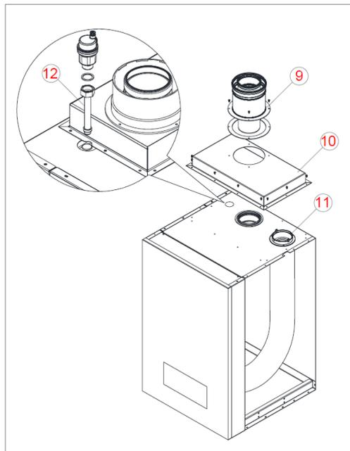
Если необходимо использовать соединение дымохода типа В23, следует использовать переходник для всасывания чистого воздуха, а отработанный газ следует отводить во внешнюю среду через трубу Ø100 мм.
