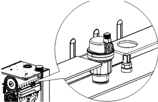
Водогрейные конденсационные котлы **WALLCON 100-150 кВт** оборудованы автоматическими воздухоотводчиками.
