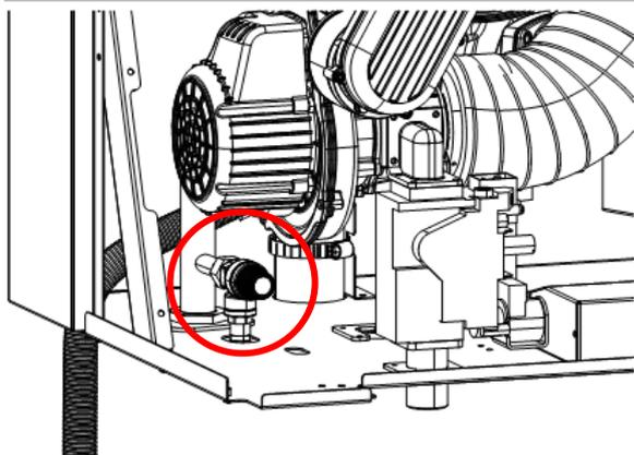
**WALLCON** оборудован встроенным предохранительным клапаном. Дренажный шланг от предохранительного клапана должен быть подключен к системе канализации.
